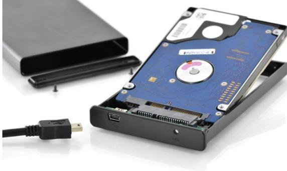
3. Far scivolare all'interno il disco rigido e fissare il vassoietto avvitando le viti
